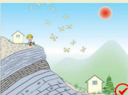
乡(镇)政府应委托专业技术人员对坡地类建设用地进行排查。应选在反向坡的坡上和坡下,避开顺向坡。
